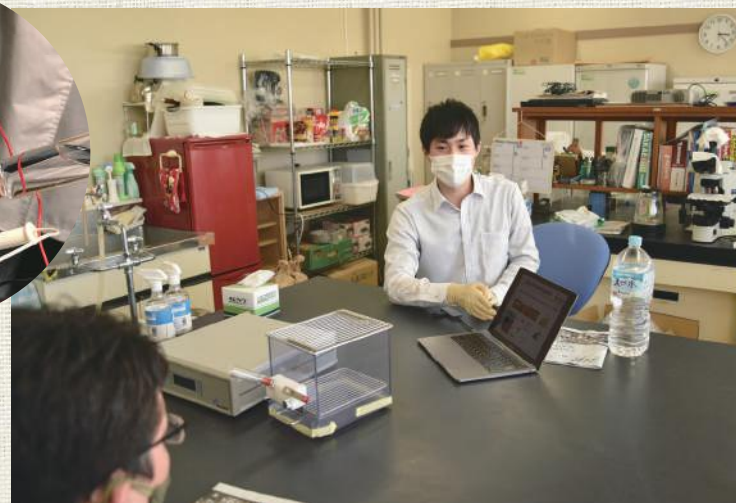
動物の味覚を測定する装置：マウスがピンに入った砂糖水を舐める回数を測定している様子
